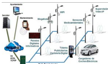
Imagen 82: Esquema de dispositivos de sensorización y control en las luminarias de Rivas
